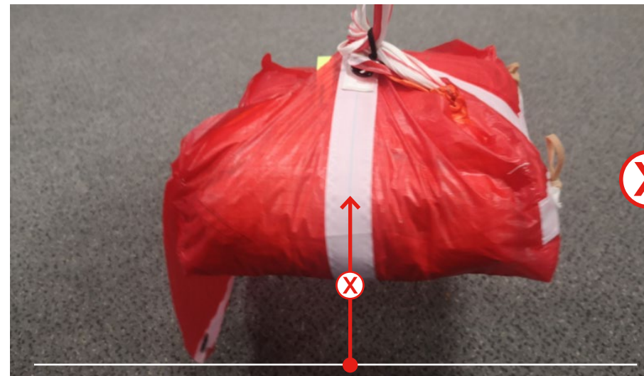
Falsch: Das im Container verpackte Rettungsgerät lässt sich an der Verbindungsleine anheben.
