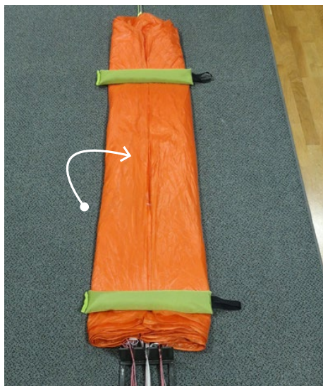
Halbiere die linke Kappenhälfte zur Mittelachse. Packgewichte helfen bei der Fixierung.
