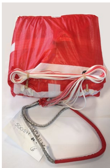
Schließe den Container mit einer 5 bis 6 cm Leinenschlaufe (ungefähr 3 Finger breit).
