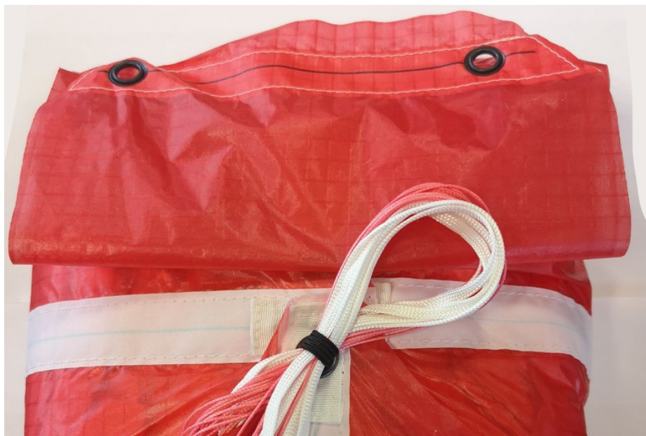
Schließe den Container mit einer 5 bis 6 cm Leinenschlaufe (ungefähr 3 Finger breit).
