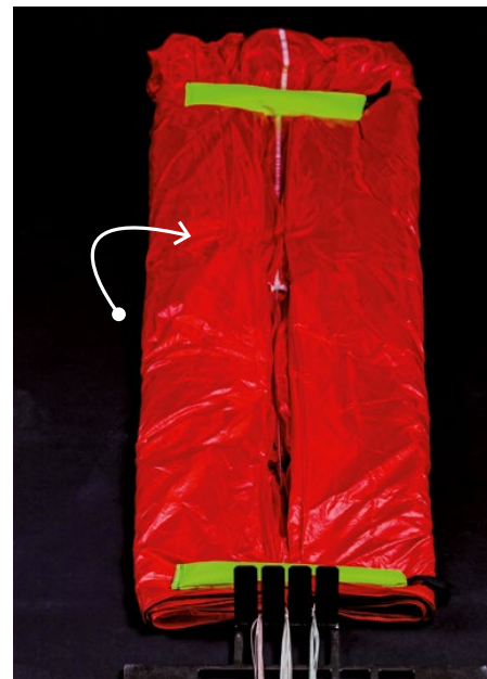
Halbiere die linke Kappenhälfte zur Mittelachse.
