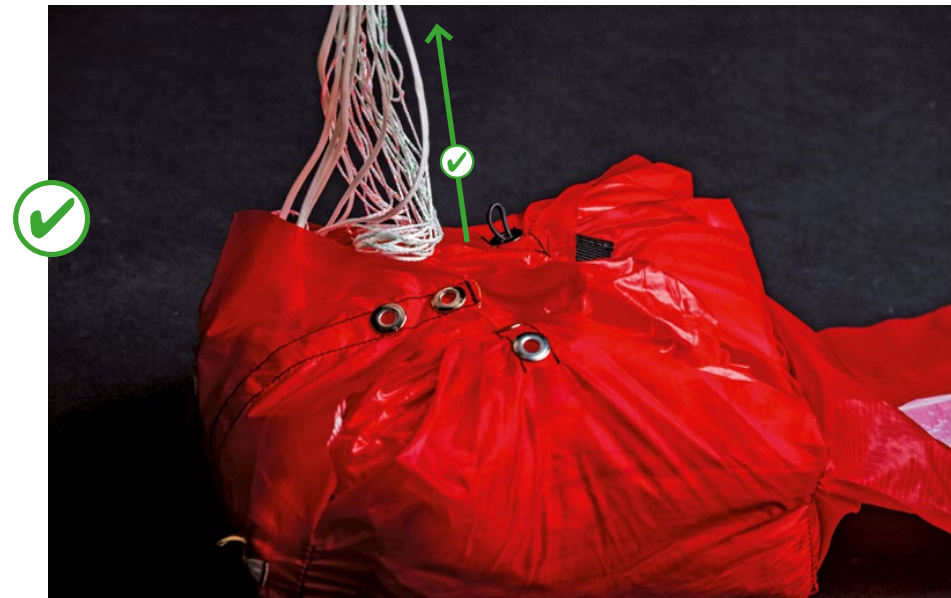
Richtig: Das im Container verpackte Rettungsgerät lässt sich nicht an der Verbindungsleine anheben.
