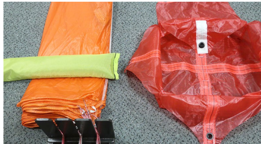
Die Kappe ist jetzt auf die Containerbreite fertig gepackt.
